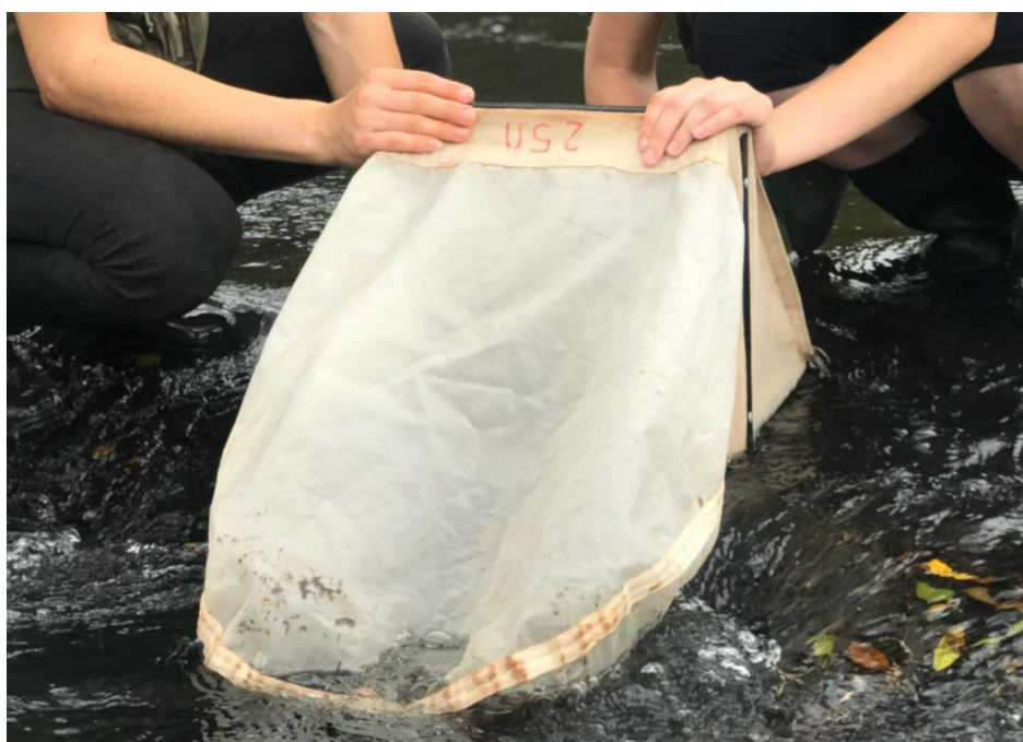
Figura 5 – Exemplo de aplicação do método Amostrador Suber na amostragem de invertebrados.
